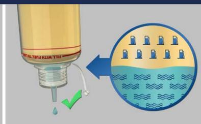
Per risultati ottimali si raccomanda **1 Litro** di campione del carburante.
