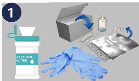
**1** Pulire gli strumenti per il campione utilizzando salviettine con 70% di alcol e lasciare asciugare. Tenere il contenuto del kit di test FUELSTAT® a portata di mano. Indossare i DPI corretti, inclusi guanti in nitrile e occhiali di sicurezza, quando si manipola il carburante.
