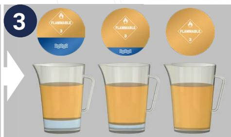
**3** Agitare il campione con un movimento vorticoso e lasciare **sedimentare per 12-15 min.** Dopo questo periodo di sedimentazione c'è dell'acqua libera?
