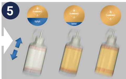
**7** Per tutti i tipi di test fissare il tappo del contagocce **escuotere vigorosamente il campione per 5 secondi**
