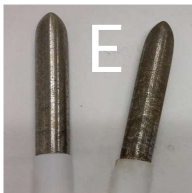
Figura 1: Sonda di riferimento: Alta Corrosività (Valutazione E).
