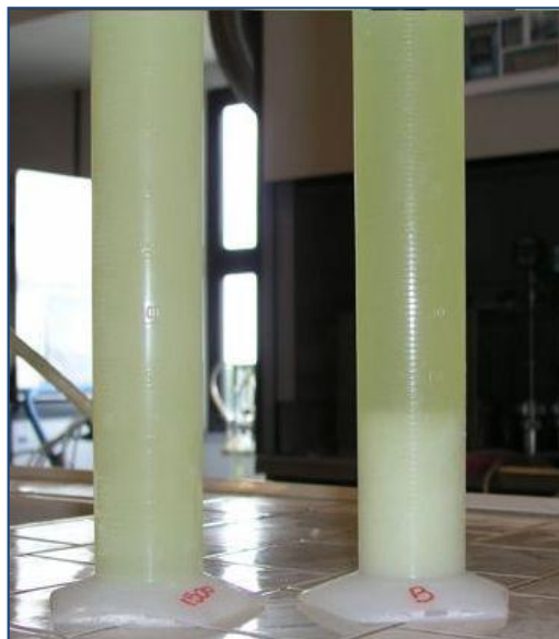
Fig. 5 – Gasolio con WAFI (sinistra) e gasolio con FI (destra)
