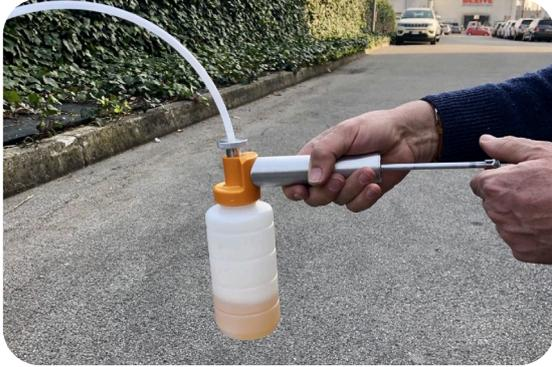
I programmi di manutenzione preventiva efficaci si basano su analisi e campionature di olio idraulico e carburante (diesel e benzina) pianificate per fornire un'accurata indicazione delle condizioni del prodotto.
