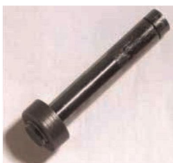
Logoramento e arresto del funzionamento del pistone sono comunemente causati dalla presenza di acqua nel carburante.
