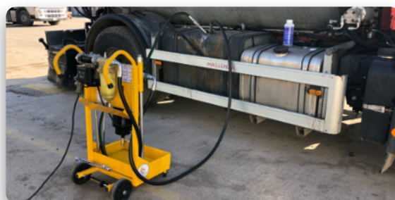
Bonifica serbatoio camion con Diesel Flux 79 e Bacspere 35
